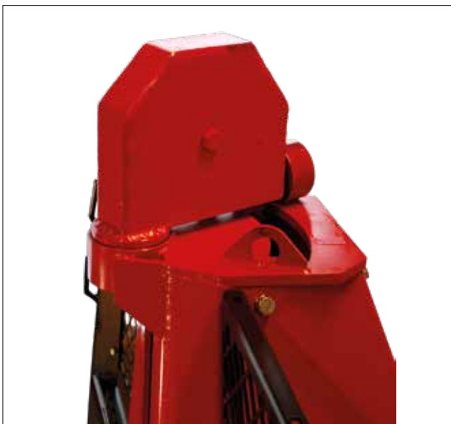
Toppblokk med spolapparat
