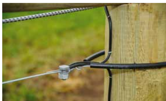
Bilde 23. Sikker trådkobling fra apparat til gjerde.
