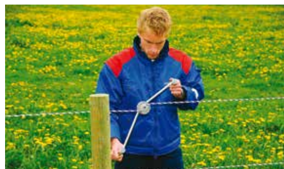
Bilde 20. Håndtaket gjør det enkelt å dra til trådstrammerene.
